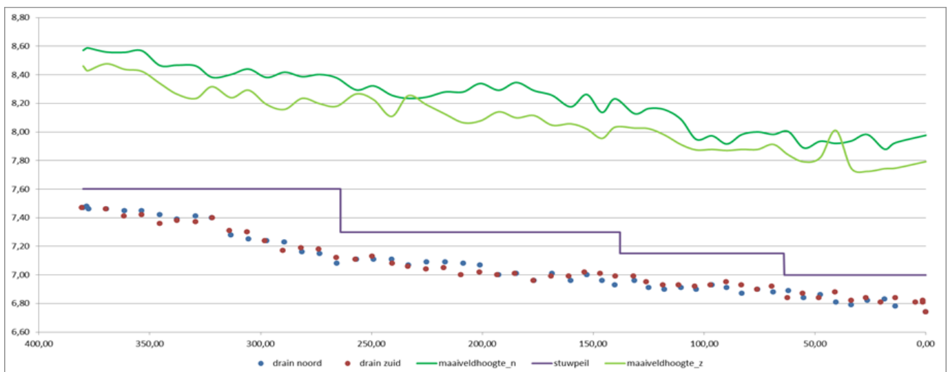
Pilot bij het Achterste diep met de hoogteligging van de drainbuizen ten opzichte van maaiveld.
