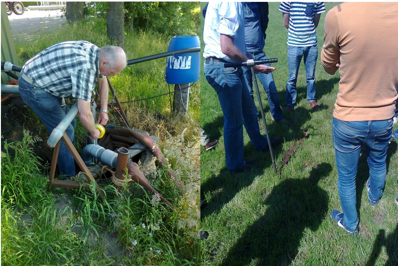
FOTO Met een logger wordt gemeten hoe diep het grondwater staat en met een grondboor wordt het bodemprofiel beoordeeld.
